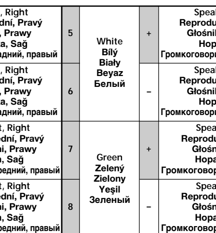
Negative polarity positions 2, 4, 6, and 8 have striped cords. Položky s negativní polaritou 2, 4, 6, a 8 mají proužkované kabely. Przewody ujemnych pozycji biegnących 2, 4, 6, oraz 8 oznaczono prążkami. Negatif güç pozisyonlarını 2, 4, 6, ve 8 kabloların çizgili. Pozisyonlar uymatıcılığında 2, 4, 6 ve 8 voltu kabloları şerhli.
